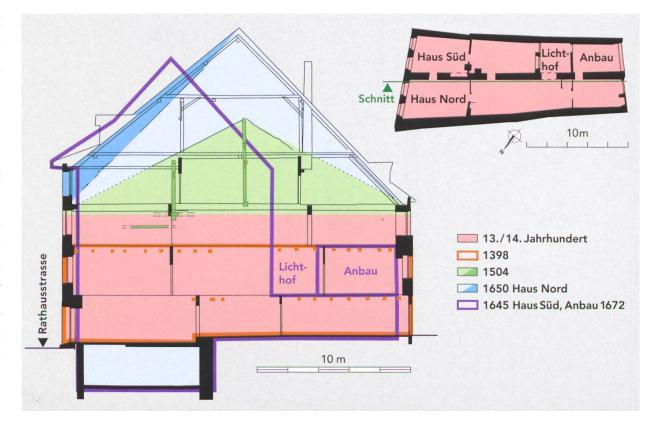
Stuhlrähm und Stuhlständer von 1504d, eingemauert in der Zwischenwand der später getrennten Liegenschaften. Im Jahre 1504d erhielt das Gebäude eine neue Dachkonstruktion, wovon sich in der zentralen Längsachse Konstruktionsbalken einer stehenden Bundebene erhalten haben. Diese wies eine auffällig flache Dachneigung von 28 Grad auf, was auf eine ursprüngliche Belegung mit Brettschindeln schliessen lässt. Diese Dachform, im Volksmund
