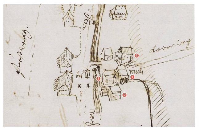
bäudes im Jahre 1679 mit zwei Wasserrädern. Später – bis zur Elektrifizierung um 1940 – trieb noch ein einzelnes Wasserrad mit einem Durchmesser von fünf Metern die Mühle an.
