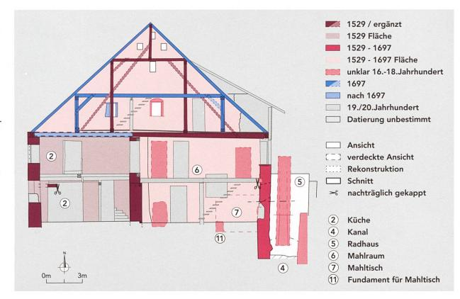
Unter dem aktuellen Boden der Mühle hat sich ein Fundamentstreifen erhalten, auf dem wohl der Mahltisch aufsetzte. zuvor bis zu den Dachbalken in 4,70 Metern Höhe reichte. Zudem war der Mahlraum einst mit einem Tonplattenboden ausgestattet.
