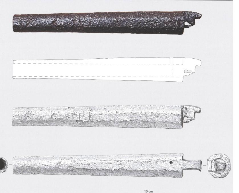
Pratteln, Adler. Das neu entdeckte Handrohr hat einen vorne runden, hinten leicht achtkantigen Lauf. Die durchgehende Bohrung ist am hinteren Ende exakt auf Höhe des Zündlochs mit einem verschweissten Zapfen verschlossen, der in einer Art Haken endet. Gesamtlänge 27,5 Zentimeter (Sarah Schäfer).
