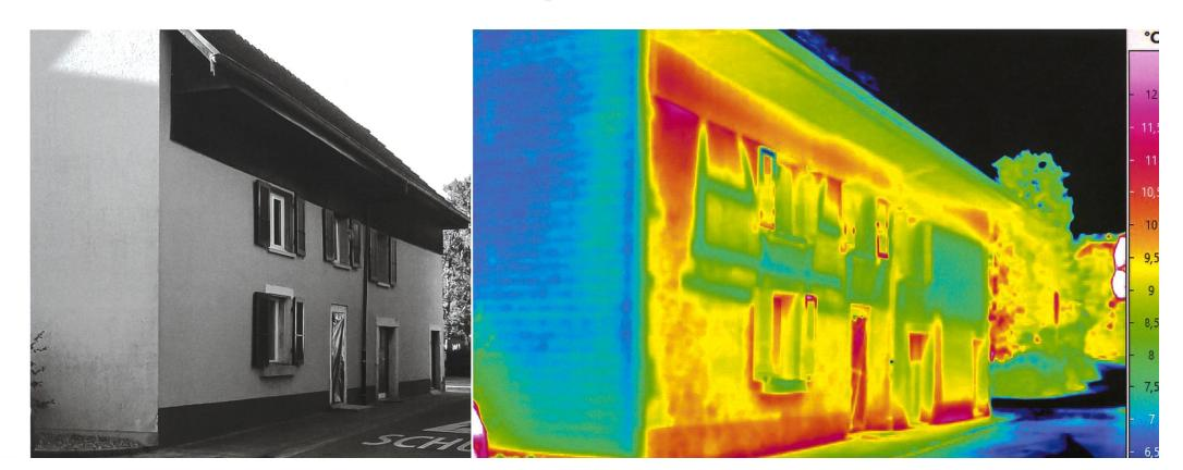
In der Thermografie der Zunzger Mühle werden zwei zugesetzte Fenster sichtbar. Weise die zugrundeliegende Struktur erkennen, was unter anderem für die zeitliche Einordnung eines Baus wichtig sein kann.
