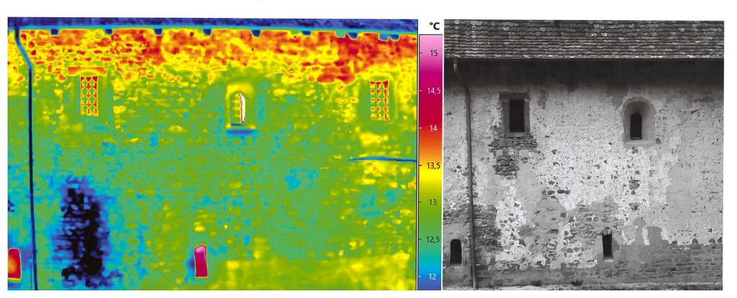
Eine Infrarot-Kamera kann die Oberflächenwärme von festen Körpern abbilden, welche die Objekte in Form von Licht im Infrarot-Spektrum an die Umgebung abgeben. Je nach Modell und Empfindlichkeit der Sensoren sind sogar Wärmeunterschiede bis zu 0,015 K (entspricht 0,015°C) erkennbar. Da die einzelnen Baustoffe verschiedene
