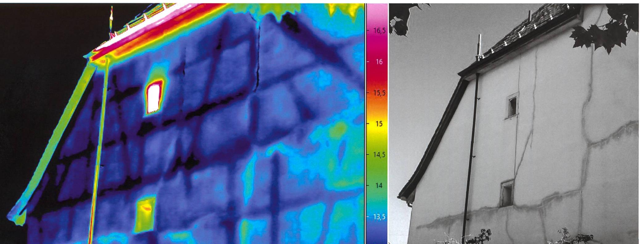
Denn da die Putz- und Malschichten im Vergleich zu den dahinterliegenden Baukörpern eher dünn ausfallen, bilden die Infrarot-Aufnahmen in der Regel nicht Erstere ab, sondern die Strukturen darunter. Wenn also beispielsweise die Sonne auf eine verputzte Fassade scheint, so wärmt sich die Fassade mit ihren Baustoffen auf. Besteht eine
