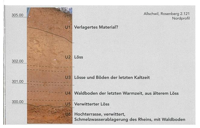
und verwitterten Lössen, wie sie andernorts aus frühen und mittleren Zeitabschnitten der letzten Vereisung bekannt sind. Ohne radiometrische Datierungen sind allerdings keine näheren Angaben zur Zeitstellung möglich. Mit Schicht U2 folgt darüber ein mehrere Meter dicker, gelber Löss, der noch kalkhaltig und somit unverwittert ist. Analoge Ablagerungen in Sierentz (F) und der Tongrube von Allschwil werden dort in die jüngste maximale Kältephase der Würm-Eiszeit um 24000 Jahre vor heute datiert.
