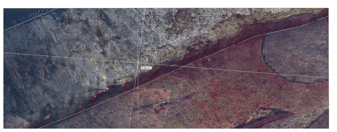
Der Laserscanner ist schliesslich in grossflächigen Projekten einsetzbar. Manchmal werden detaillierte Geländemodelle von ganzen Hügelzügen oder Talböden benötigt. In so erzeugten Aufnahmen zeigen sich kleinste Unebenheiten des Bodens, die beispielsweise Hinweise auf alte Wege oder erodierte Wallanlagen geben können. Sie haben dabei einen höheren Detaillierungsgrad als die Daten, die beim Scan aus dem Flugzeug (airborne laserscanning LIDAR) erhoben werden.
