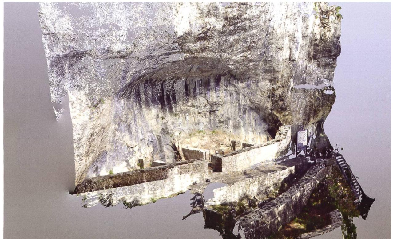
Die lagerichtig im Raum positionierte Punkt-wolke dient am Bild-schirm als Grundlage für die Erstellung drei-dimensionaler Linien.
