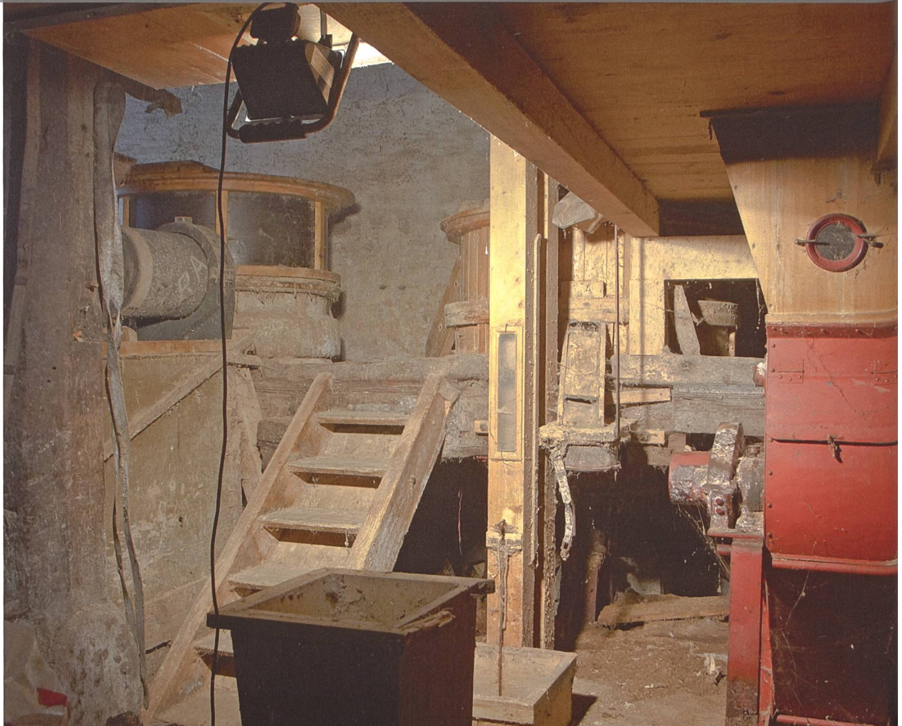
Zeglingen, Untere Mühle. Blick in den Mühlraum mit Mahlstein, Röllgang und Sichtertrichter.
