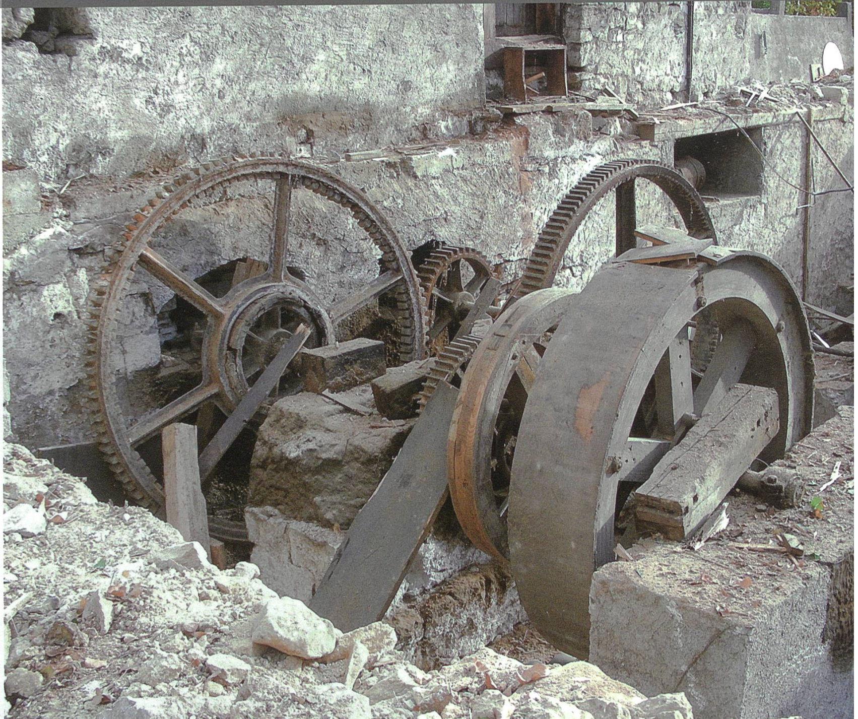
Bubendorf, Hauptstrasse 63. Zahnräder, Wellen und Riemenscheiben – Teile des Getriebes der Sägerei während des Abbruchs.
