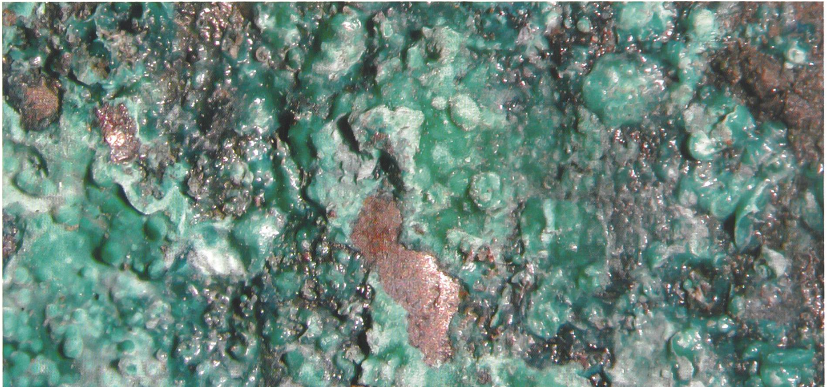
Grüne Korrosion auf der Silberoberfläche einer Münze.
