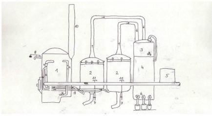
Schülerzeichnung der Brennerei: 1. Dampfkessel / 2. Maischkessel / 3. Destilierhafen / 4. Kühler / 5. Werkzeug / 6. Schnapsausläufe / 7. Ablauf / 8. Überdruckventil / 9. Dampfzuleitung / 10. Kamin / 11. Auslaufhahn
