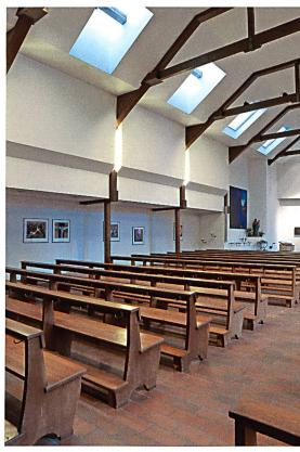
Die Fenster im Obergaden weichen schrägen Dachfenstern. Die Binder werden verschalt und durch ein Hängewerk ersetzt. Foto P. Schärer, Januar 2016.
