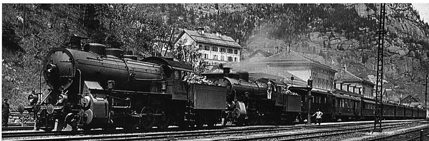
Um 1910, ein Jahr nach der Verstaatlichung der Gotthardbahn, erreicht die Dampftraktion auf der Gotthardlinie ihren absoluten Höhepunkt. Eine A 3/5 Schnellzuglokomotive führt den schweren Express, eine C 4/5 Güterzuglok leistet ab Erstfeld Vorspann; beide noch von der Gotthardbahn beschafften Lokomotiven waren damals die modernsten und stärksten Maschinen auf der Bergstrecke. Der Betriebshalt in Göschenen betrug in jenen Jahren noch gut 25 Minuten, wovon das Bahnhof-Buffer Göschenen mit seinem berühmt gewordenen Perron-Service (heisse Suppe, Brot und Würstchen) jahrzehntelang profitierte.
