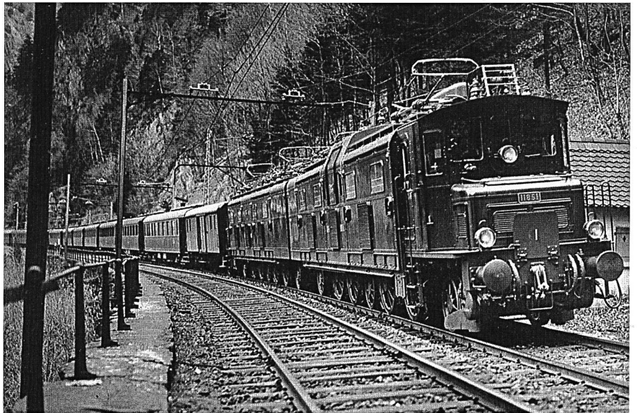
Als 1928 infolge der massiven Verkehrszunahme die Anhängelasten erhöht wurden, entstanden 1931/32 die beiden Doppellokomotiven der Serie Ae 8/14 (im Bild die Nr. 11851). Die 34 Meter langen und 240 Tonnen schweren Maschinen vermochten mit über 11000 PS rund 770 Tonnen Anhängelast im Bergdienst zu befördern. 1939 folgte als dritte und letzte Einheit dieser imposanten Lokreihe die berühmte «Landilokomotive (Nr. 11852) auf der Gotthardlinie.
