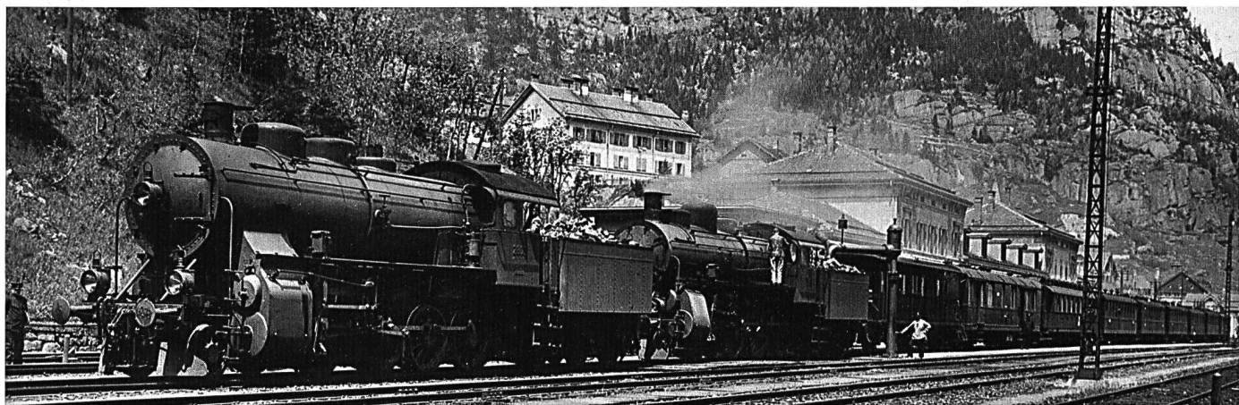
Um 1910, ein Jahr nach der Verstaatlichung der Gotthardbahn, erreicht die Dampftraktion auf der Gotthardlinie ihren absoluten Höhepunkt. Eine A 3/5 Schnellzuglokomotive führt den schweren Express, eine C 4/5 Güterzuglokomotive leistet ab Erstfeld Vorspann; beide noch von der Gotthardbahn beschafften Lokomotiven waren damals die modernsten und stärksten Maschinen auf der Bergstrecke. Der Betriebshalt in Göschenen betrug in jenen Jahren noch gut 25 Minuten, wovon das Bahnhof-Buffer Göschenen mit seinem berühmt gewordenen Perron-Service (heisse Suppe, Brot und Würstchen) jahrzehntelang profitierte.
