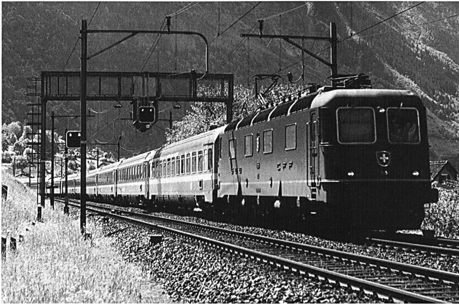
Eine Re 6/6 führt den IC 302 — mit modernen «Eurofima»-Kurswagen — Chiasso—Zürich—Stuttgart und Napoli—Zürich/Basel nordwärts. Hauptstütze der Zugförderung im hochwertigen schweren Schnellzugverkehr ist nach wie vor die zwischen 1973 und 1980 beschaffte Re 6/6, die mit 120 Tonnen Dienstgewicht und einer Leistung von 10 600 PS rund 800 Tonnen Anhängelast mit 80 km/h bergwärts zieht, wobei sie als Mehrzwecklok auch im Güterverkehr vorzügliche Leistungen erbringt. Dank möglicher höherer Kurvengeschwindigkeit konnten zwischen Luzern und Chiasso 12 Minuten eingespart werden.
