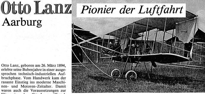
Otto Lanz auf dem Sitz seiner Eigenkonstruktion. Interessant sind die nach oben gebogenen Gleitkufen zwecks Verhinderung eines Überschlags nach vorn bei etwas zu abrupter Landung.
