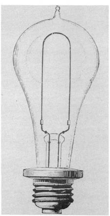
Bild 5 Endgültige Formgebung der Edison-Kohlenfaden-Glühlampe aus dem Jahr 1881 mit dem heute noch gebräuchlichen Edison-Schraubsockel.
