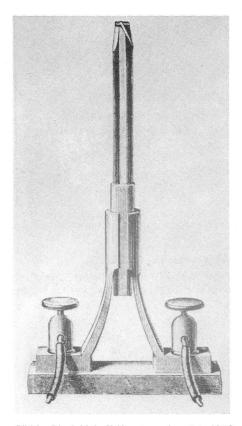
Bild 1 Die Jablokoff-Kerze aus dem Jahr 1876 strahlte ein ruhig glühendes, intensives Licht aus. Die parallel gelagerten Kohlestäbchen, deren Enden mit einem Graphitplättchen verbunden sind, empfingen den Strom aus einem Stromerzeuger (Dynamo).
