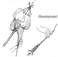
Aus dem Spinngut führt die linke Hand einige Wollhaare zu der in der rechten Hand gehaltenen Handspindel, die in Drehung versetzt wird. Die Haare schliessen sich nun durch den entstehenden Drall zu einem Faden zusammen. Hat die Spindel den Boden erreicht, wickelt man das Garn zwischen Scheibe und Haken. Mit viel Übung entsteht ein leichter, einfacher Rhythmus.
