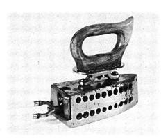
Deutsches Gasbügeleisen um 1900. Der Brenner wird eingeschoben. Gleichzeitig wird eine Kräuselschere im Eisen erhitzt. (Gewicht 3300 Gramm).
