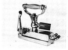
Dampfbügeleisen «Champer Press» bei Ritex Zofingen bis 1940 in Gebrauch. Vollbeweglich an freiem Arm. (Gewicht 14,5 kg). Es handelt sich um ein ausgesprochenes Industriegerät.
