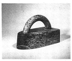
«Speckstein»-Bügeleisen aus Gotthard-Serpentin. Vorteil: sie speicherten die Wärme über Stunden hinweg.
