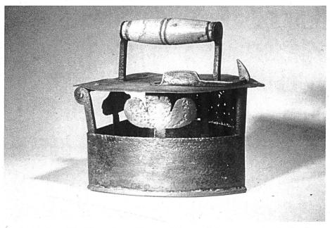
Handgearbeitetes Bügeleisen mit geschlossener Seite zum Schutz gegen austretendes Gas. Toscana 1750 – 1800 (Gewicht 1660 Gramm).
