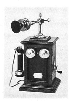
**1900:** Batterie-Tischstation Hasler. Besonderheit: horizontal drehbarer Mikrophonarm.
