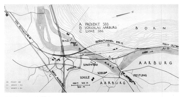
Die Planskizze aus dem Jahr 1967 zeigt: A Variante Projekt 66, B Vorschlag Aarburg Variante Nord. Die ausgeführte Variante entspricht der unteren, nahezu gestreckten Linie mit einem ca. 800 Meter messenden Höflitunnel.
