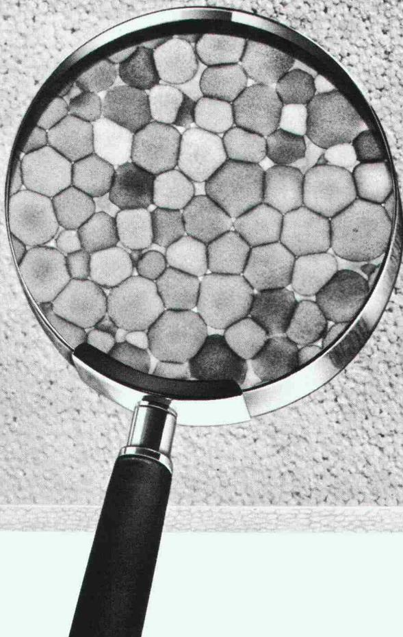
**1 m<sup>3</sup> Polystyrol-Hartschaum besteht aus rund 3-6 Milliarden mikroskopisch kleinen luftgefüllten Zellen. Darauf beruhen die hervorragende Wärmedämmfähigkeit und die hohe Druckfestigkeit von Polystyrol-Hartschaum. Das leichte Eigengewicht und die vielen anderen vorzüglichen Eigenschaften machen Polystyrol-Hartschaum zum idealen Isoliermaterial.**
