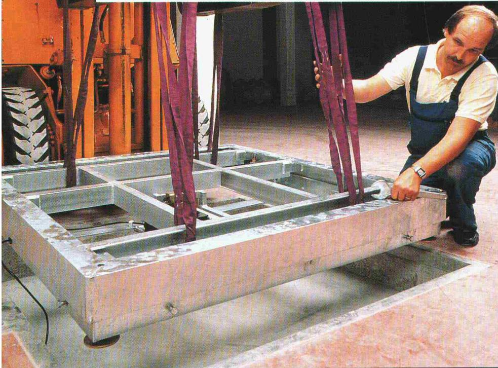
Die robusten und präzisen Industriewaagen von METTLER funktionieren als Sensoren im Materialfluss und lassen sich leicht in Transportsysteme integrieren. Die Schnittstelle zur Betriebsdaten-Erfassung oder an Prozess-Rechner gehört zur Systemintegration der modernen METTLER Waage.
