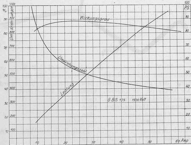
Abb. 4. Charakteristische Kurven bei 1500 Volt Betriebsspannung.
