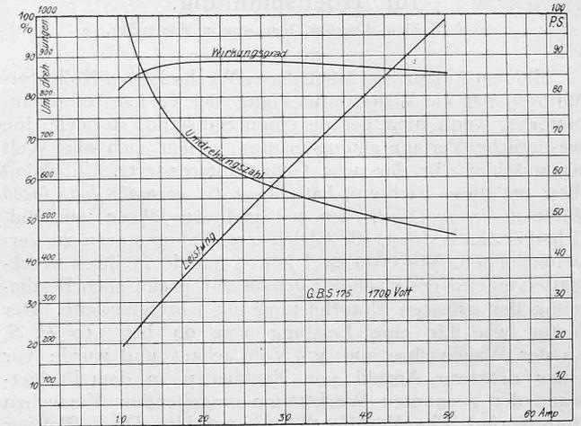
Abb. 5. Charakteristische Kurven bei 1700 Volt Betriebsspannung.
