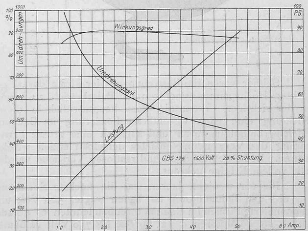
Abb. 6. Charakteristische Kurven bei Shuntung von 28%.
