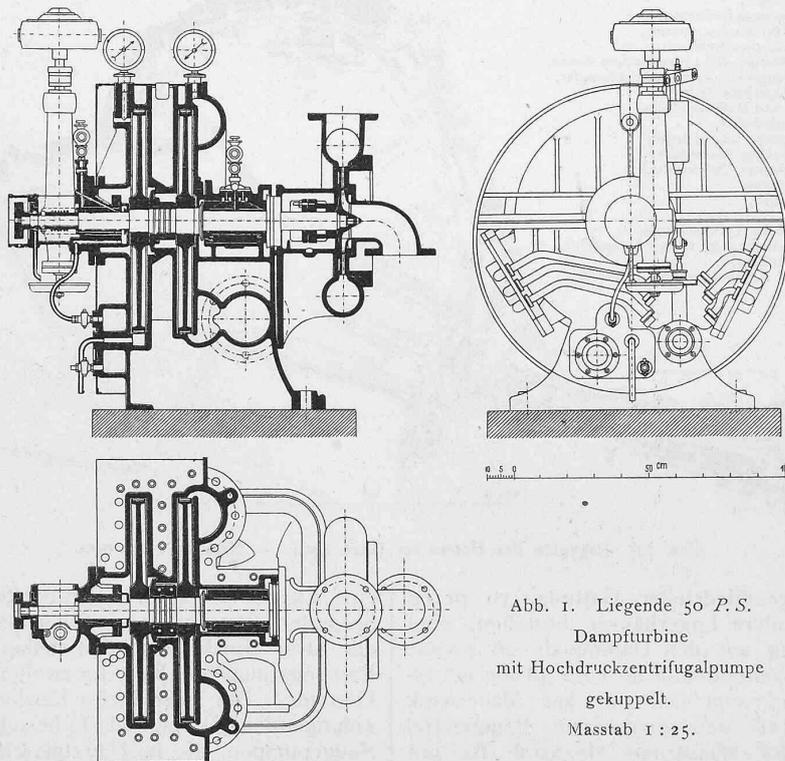
Abb. 1. Liegende 50 P. S. Dampfturbine mit Hochdruckzentrifugalpumpe gekuppelt. Masstab 1 : 25.
