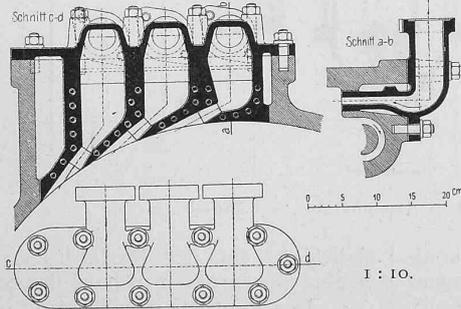
Abb. 2. Düsenapparat.
