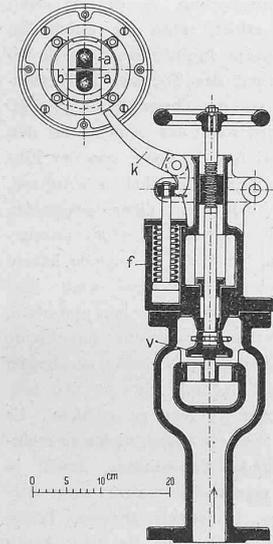
Abb. 6. Sicherheitsregulator mit Schnellschlussventil. Masstab 1 : 10.
