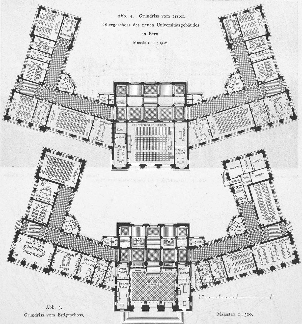
Abb. 4. Grundriss vom ersten Obergeschoss des neuen Universitätsgebäudes in Bern. Masstab 1 : 500.
