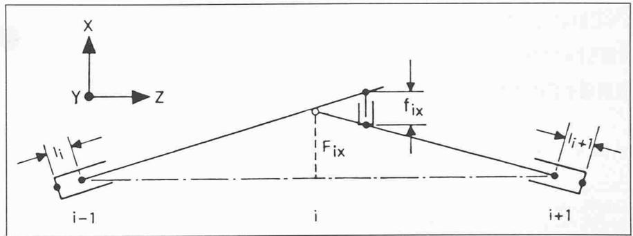
Bild 3. Die Messgrössen  $l_i$ ,  $l_{i+1}$ ,  $f_{ix}$  und  $f_{iy}$
