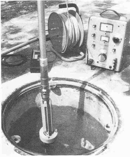
Bild 20. Gleitmikrometer-ISETH, Einführen der Messsonde in ein Bohrloch
