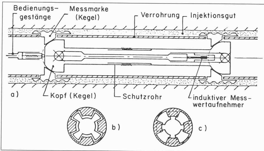
Bild 16. Gleitmikrometer-ISETH
