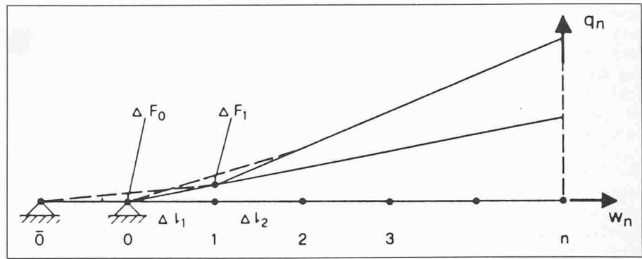
Bild 7. Bestimmung der Verschiebung  $q_n$  normal zur Bohrlochachse
