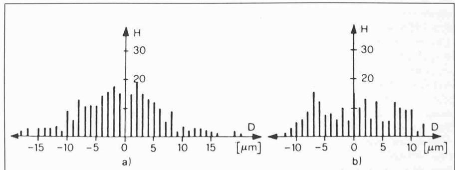
Bild 10. Histogramme unabhängiger Setzungen bei einer Feldmessung mit dem Extensio-Deflektometer ISETH für a) Verschiebungen normal zur Bohrlochachse ( $F_x$ ,  $F_y$ ) b) Axialverschiebungen ( $l$ ) ( $H$ : Häufigkeit der Setzungen,  $D$ : Abweichung vom Mittelwert)
