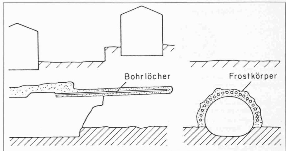
Bild 13. Gefrierverfahren. Messung der Initialabweichung der Bohrlocher (Milchbuckttunnel)
