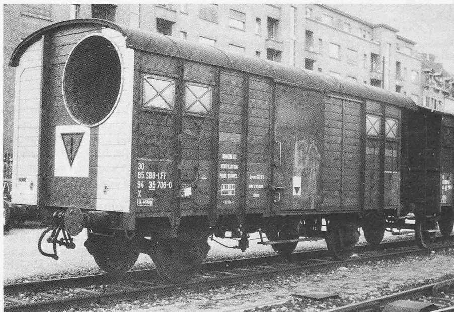
Stirnseitig ist die Luftansaug- bzw. Ausstossöffnung angebracht
