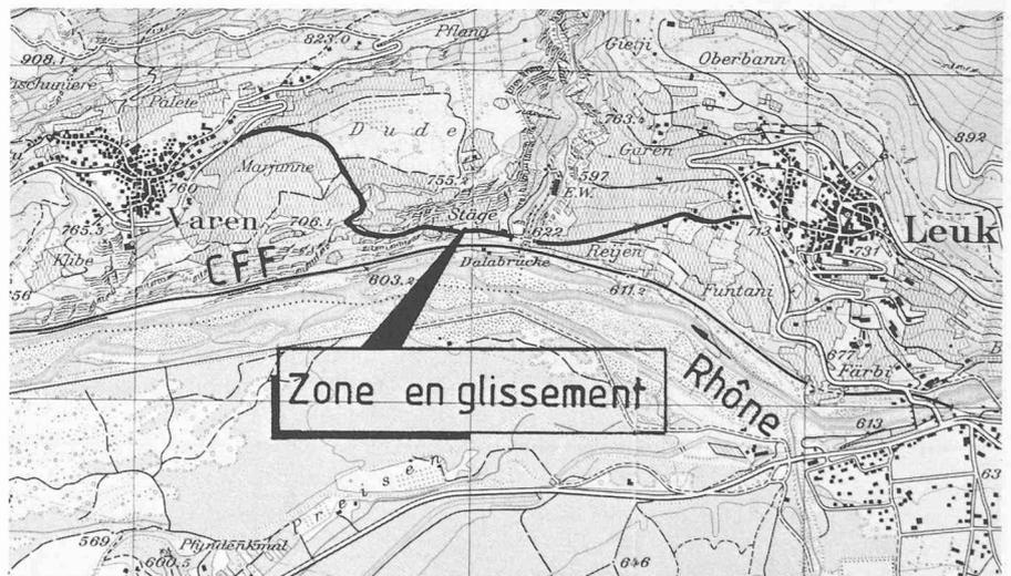
Fig. 1. — Plan de situation 1 : 25 000 — avec la zone en glissement.
