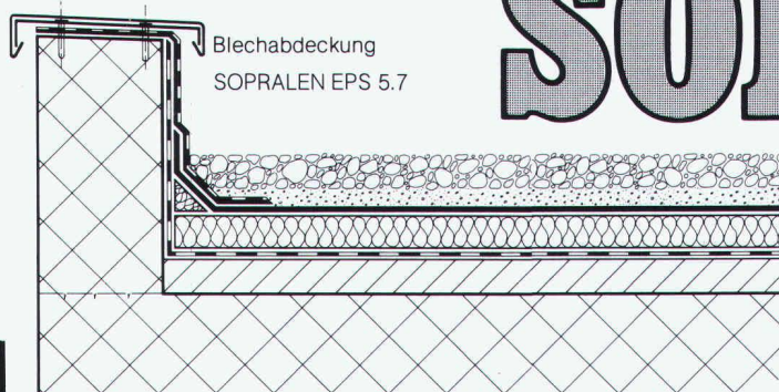
Schutzschicht SOPRALEN EJ 3.5 + EV 3.2 Wärmedämmschicht Dampfsperre
