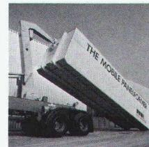
Die BEMO-Profile können mit eingefalzter Gummidichtung ausgerüstet werden. Sie sind in Aluminium, Stahl, Kupfer, Zink und Chromstahl in Baubreiten von 250-600 mm und in Materialdicken von 0,4-1,2 mm lieferbar. Um noch rationeller arbeiten zu können, haben wir die mobile Fabrikation «THE MOBILE PANELFORMER» entwickelt. Mit diesem computergesteuerten Walzwerk fabrizieren wir genau nach Einsatzplan vor Ihrer Haustüre. Dadurch können teure Transportkosten eingespart werden.
