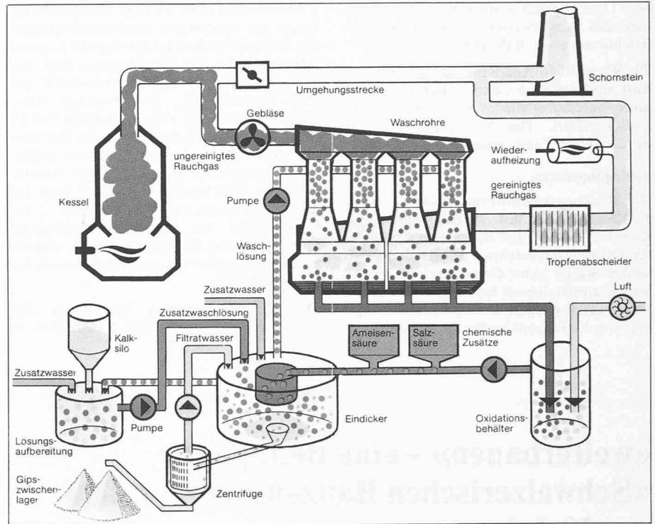
Bild 1. Schema der Rauchgasentschwefelung nach dem Kalkwaschprinzip
