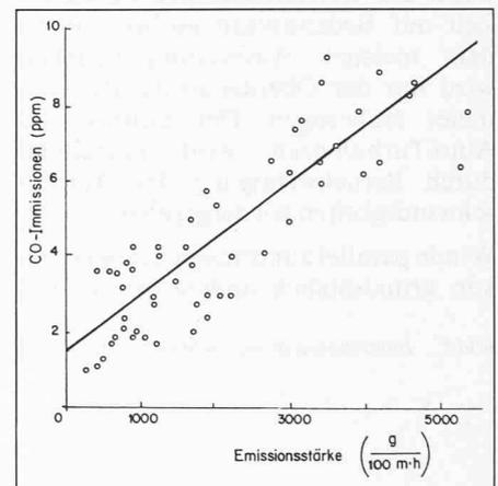
Bild 1. Immissionen in Funktion der Emissionsstärke (aus [7])
