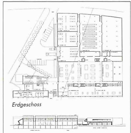
Das gewählte einfache Gliederungs- und Konstruktionsprinzip ermöglicht eine grosse Variabilität in der Funktionszuordnung.
