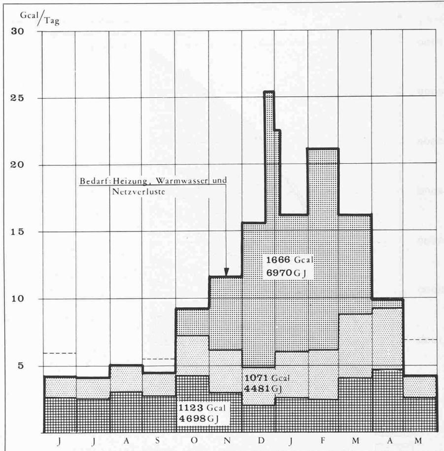
Bild 13 Wärmebilanz, Klimadaten 1969. Anschlussleistung gemäss Bild 4.
