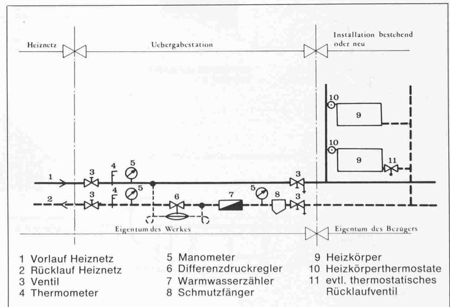
Bild 8. Hausanschluss Heizung, Hausinstallation neu
