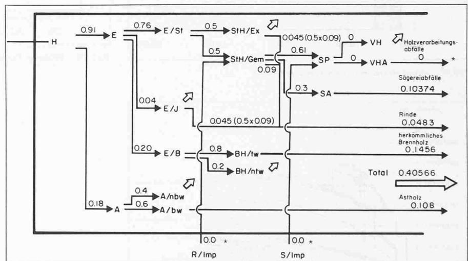
Bild 15. Flussdiagramm der Energieholzanteile als Funktion des Hiebsatzes und der Importe der Gebietseinheit
