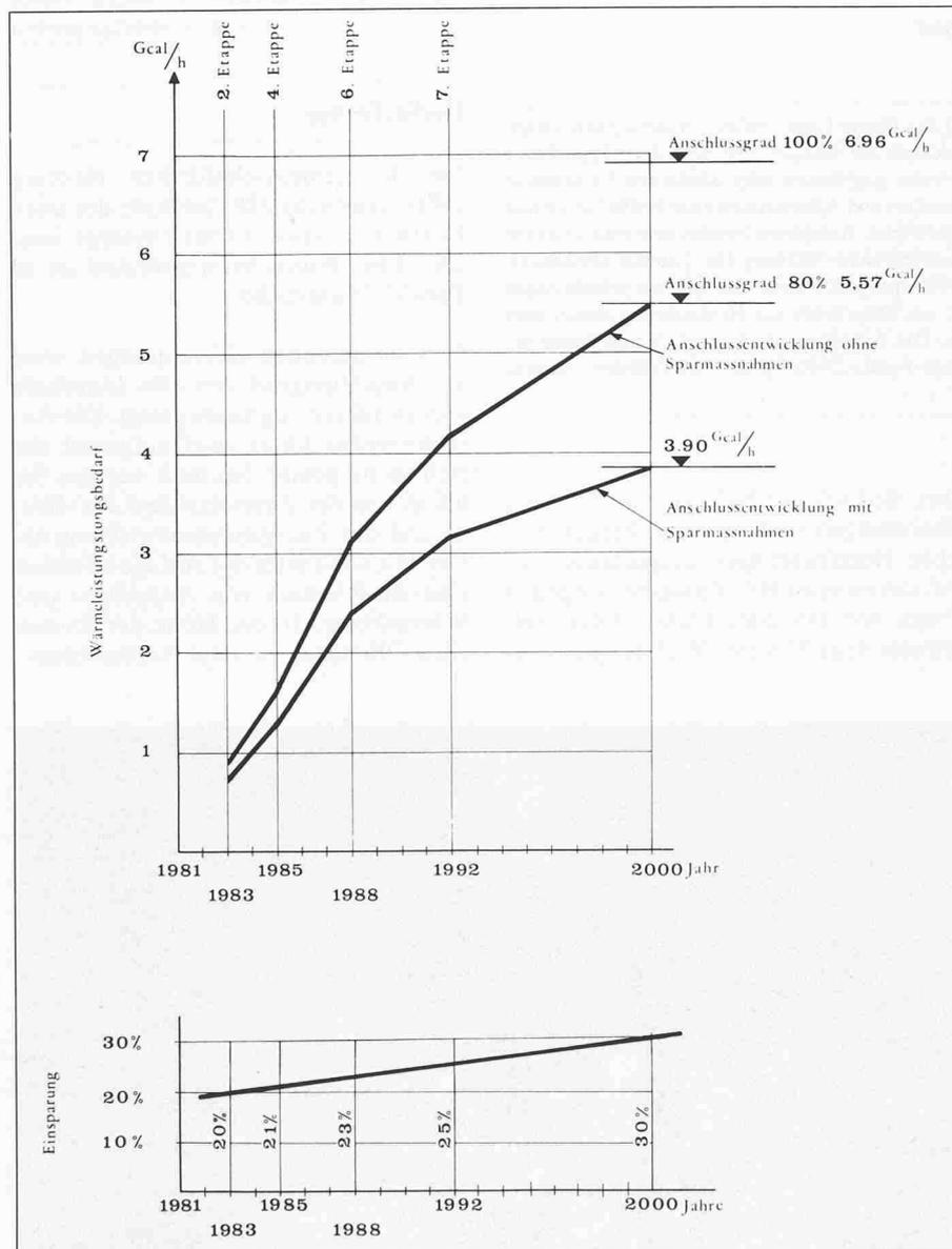
Bild 2. Oben: Angenommene Entwicklung des Wärmeleistungsbedarfs bis zum Jahre 2000. Unten: Angenommener Verlauf der Einsparungsmöglichkeiten gegenüber der durchgeführten Wärmeleistungsbedarfsberechnung
