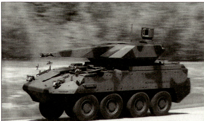
Geschützversion 35 mm des «Skyranger» auf einem Schützenpanzer «Piranha III».
