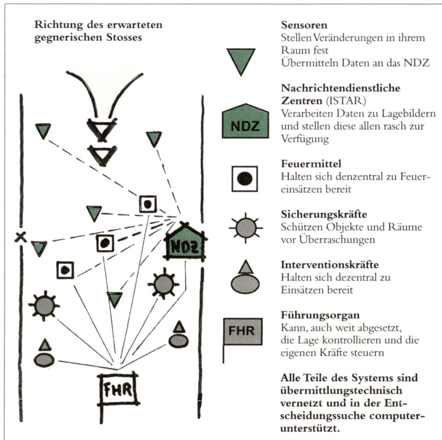
Vereinfachte schematische Darstellung C4ISTAR-System.
