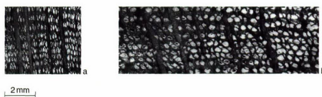
Fig. 10. Bouclier MAR-LT-18649. a L'agrandissement d'une des sections met en évidence l'écrasement latéral des pores de printemps; b Le rétablissement de la forme ronde de ces derniers permet d'évaluer l'épaisseur initiale du bouclier (pores agrandis 3×).
