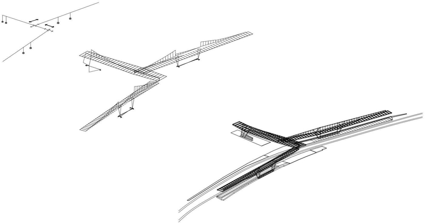
Oben: Auflageranordnung (oben links), Momentendiagramm (Mitte), Isometrie der Gesamtanlage
