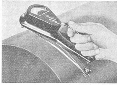
Pyrometer für Oberflächen-Temperaturen.
