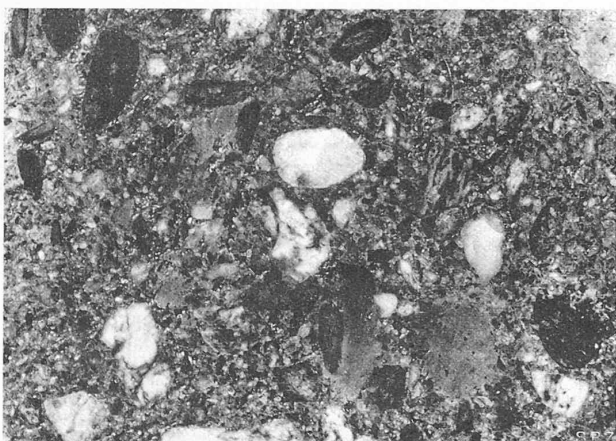
Abb. 13. Gewölbeton-Schliff, in natürlicher Grösse.
