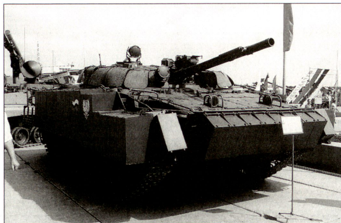
Kampfschützenpanzer BMP-3 mit Zusatzpanzerung.
