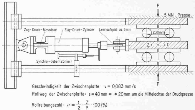
Bild 1. Rollenlager. Schematische Versuchsanordnung zur Bestimmung der Rollreibung
