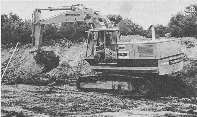
Der 23 Tonnen schwere Caterpillar 225 ist der zweitkleinste der Typenreihe. Er wird im belgischen Caterpillar-Werk hergestellt und weist alle technischen Merkmale auf, durch die sich die grösseren und stärkeren Modelle 235 und 245 auszeichnen: Leistungsstarke Hydraulik mit verstellbaren Axialkolbenpumpen, Caterpillar-Fahrwerk und Caterpillar-Motor
