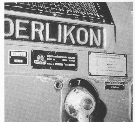
Bild 10. Objekt-Nummer-Schild und Schmieranleitung
