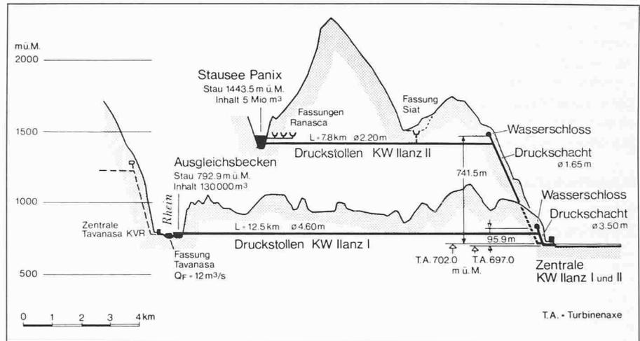
Bild 2. Längenprofil
