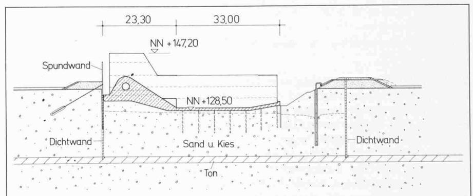
Bild 5. Schnitt durch den mittleren Teil des Wehres mit fester Wehrschwelle
