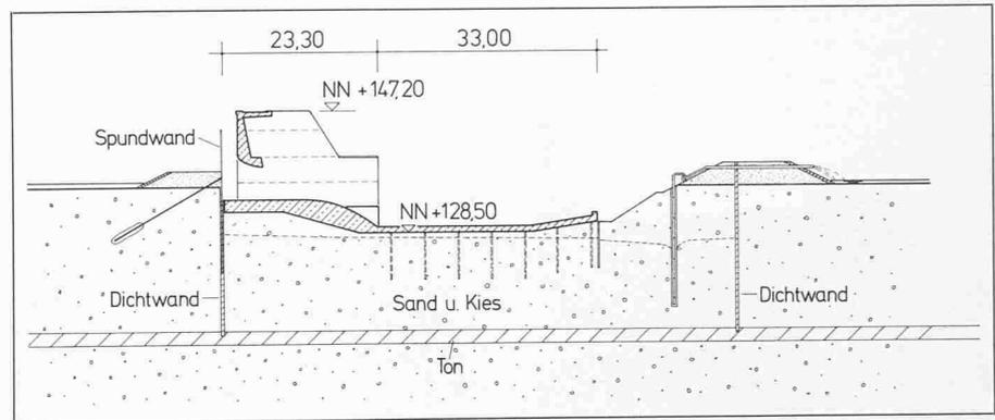
Bild 3. Schnitt durch das Staubalkenwehr
