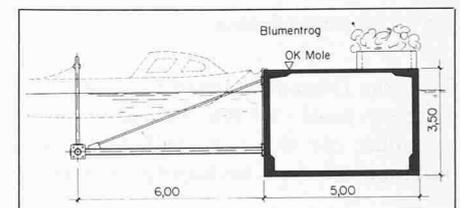
Bild 5. Querschnitt durch schwimmende Mole mit Kleinbootanliegeplätzen
