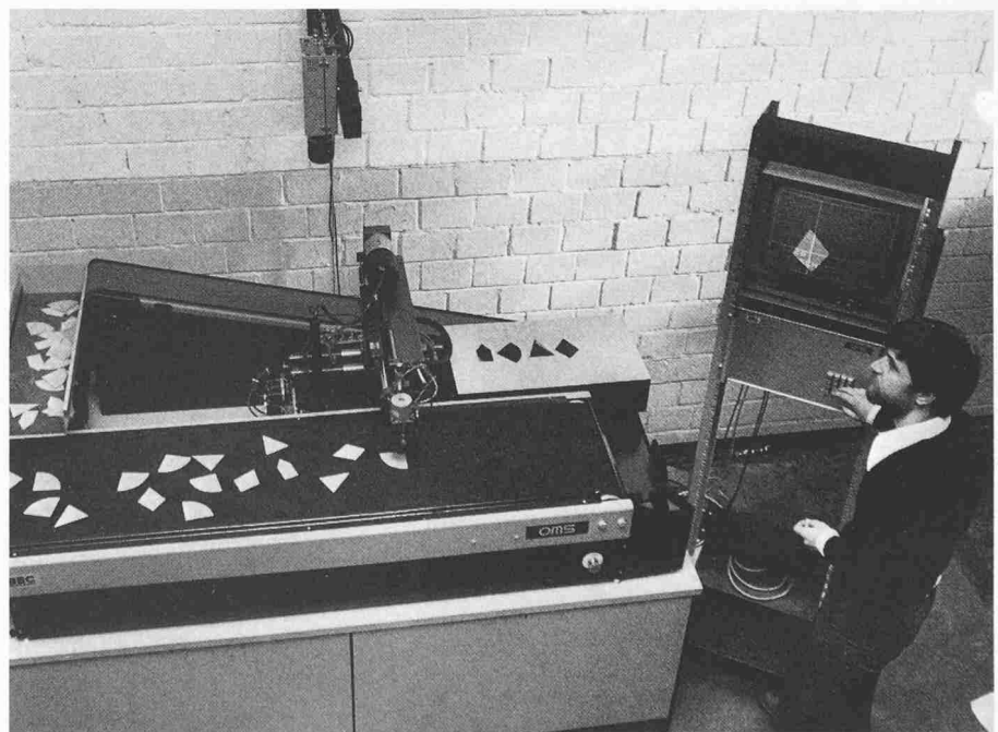
Das «Auge» des Roboters ist eine Fernsehkamera (oben), das «Gedächtnis», das die Stanzteile auf dem Fliessband identifiziert, ein Mikroprozessor (rechts), sein Arm ein Manipulator, der die Teile ergreift und so genau über die entsprechenden Löcher des Ablagekastens hält, dass sie hineinfallen können
