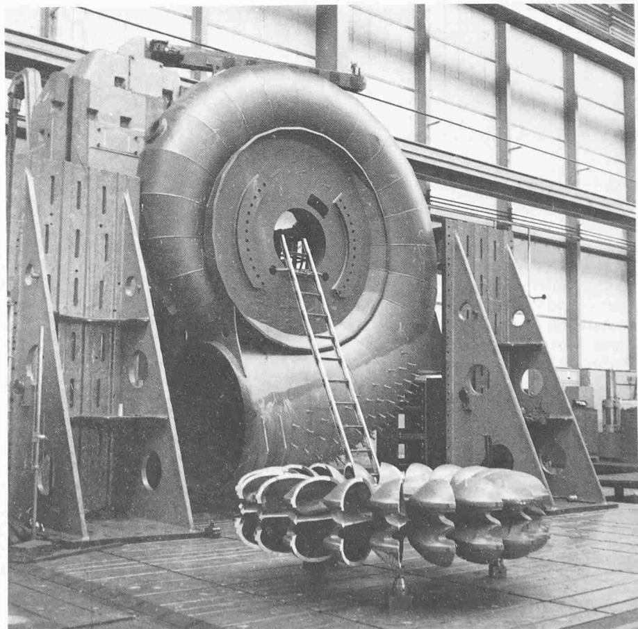
Fig. 1. Bache spirale dans les ateliers de fabrication
