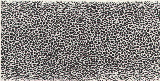
**Geschlossene Zellstruktur.** In einem speziellen Extrusionsverfahren entsteht ein Hartschaum mit vollkommen geschlossenen Zellen und einer hochverdichteten Oberfläche.
