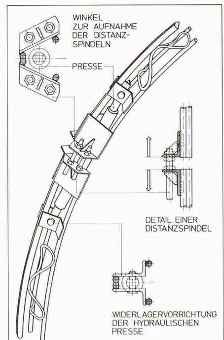
Bild 2. Zentrische Vorspannung eines Gitterträgers (Betzle)
