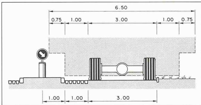
Bild 5. Integration des Spezialtransportprofils im Bereich Pförtner
